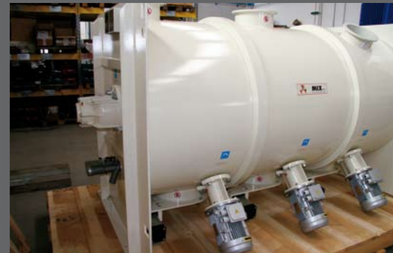
Pflugscharmischer MXC 3400 aus Normalstahl für Baustoffe
