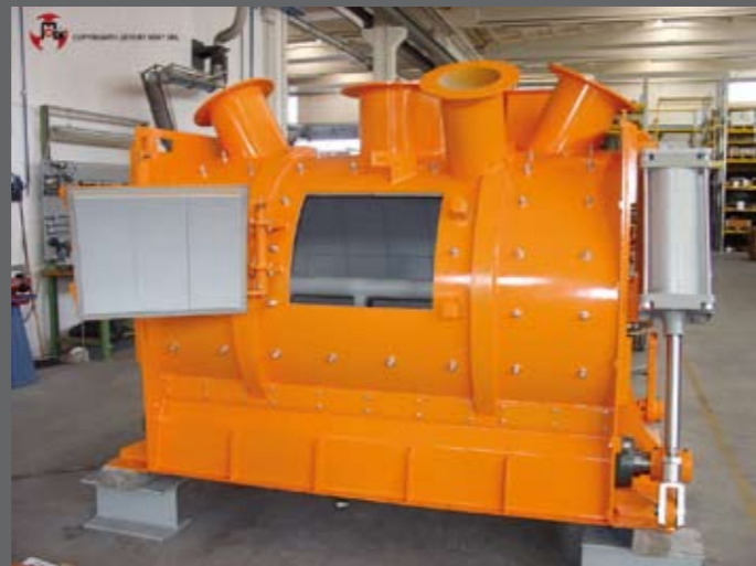
Mischer mit geschraubter Schweißschutzlackierung
