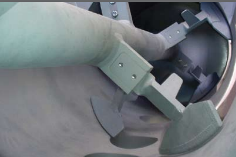
Aufschweißung auf dem Profil der Mischwerkzeuge
