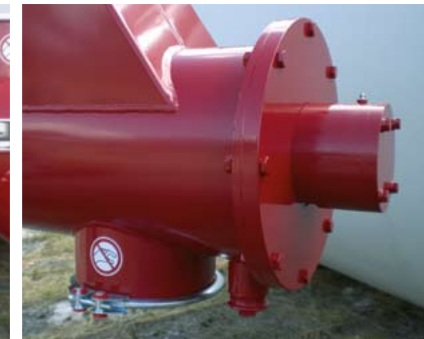
Einlaufendlager bei auslaufseitiger Antriebsmontage
