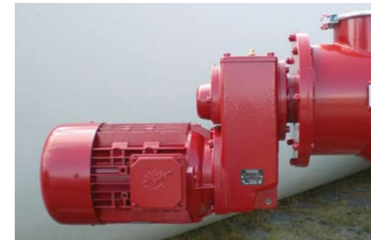
Antrieb Fabrikat Nord (Lackierung Sonderfarbton)
